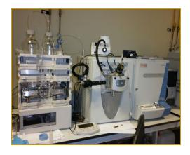
De esta forma se pueden analizar de forma automática mezclas complejas de péptidos con una muy alta sensibilidad programando el analizador para que fragmente "todas" las especies ("Exclusión Dinámica") contenidas en la mezcla ó un número determinado de péptidos ("Monitorización de iones aislados-SMIM") si disponemos de información adicional (previa) sobre su masa. Este último método se emplea principalmente para la caracterización de modificaciones postraduccionales.
